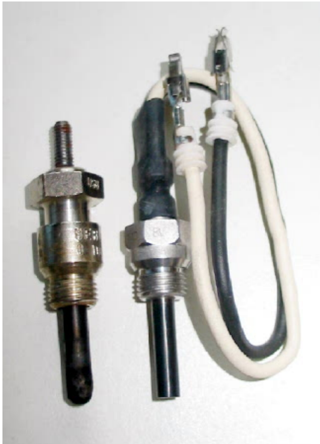
Керамическая свеча в сравнении с металлической
